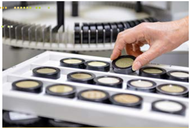
Analytik aus Grub: Futtermittelproben in Messzellen für die Nahinfrarot-Spektroskopie
