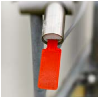
Wie ein „künstliches Blatt“ – der Sensor für die Blattnässe
