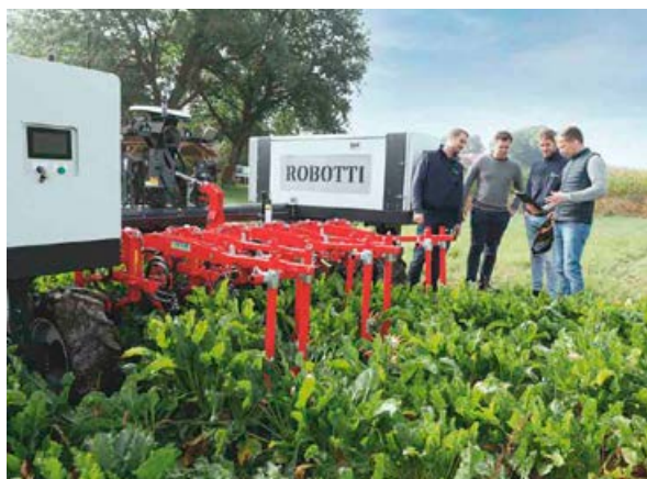
Modernste Agrartechnik: Der Rübenroboter kann über Tablet gesteuert und mit Rübensamen befüllt werden, Handsensoren messen den Nährstoffbedarf der Pflanzen (rechts).
