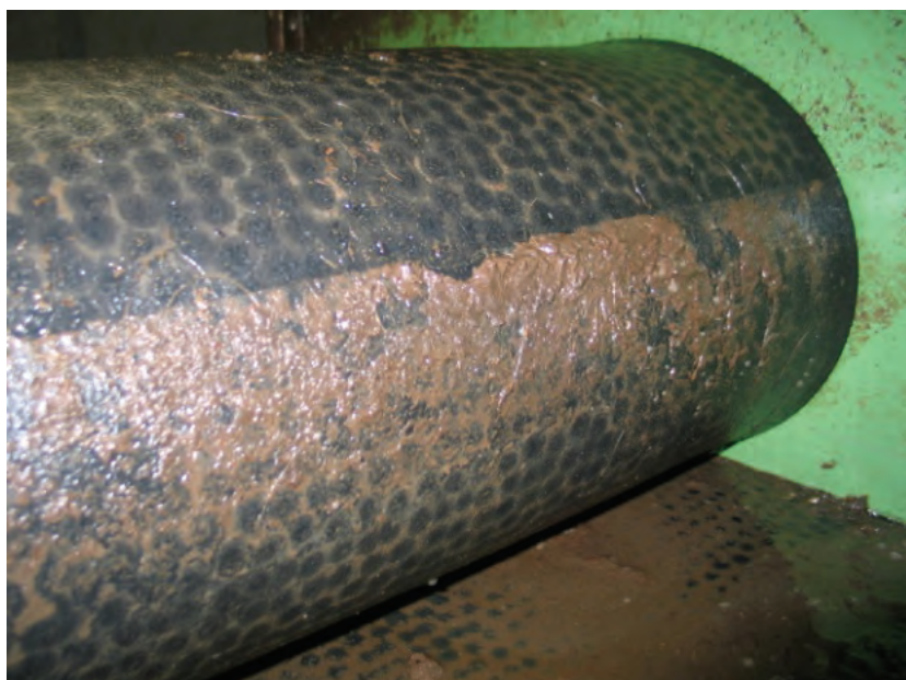
Abb. 13: Unter den Matten lagerte sich nur wenig Schmutz ab
