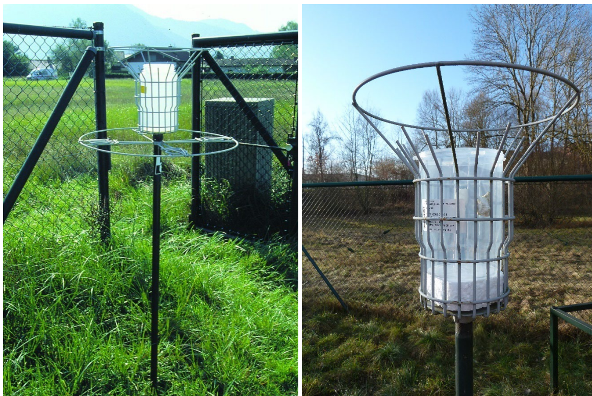
Abb. 123: Depositionssammler nach Bergerhoff (Quelle: Bayerisches Landesamt für Umwelt).
