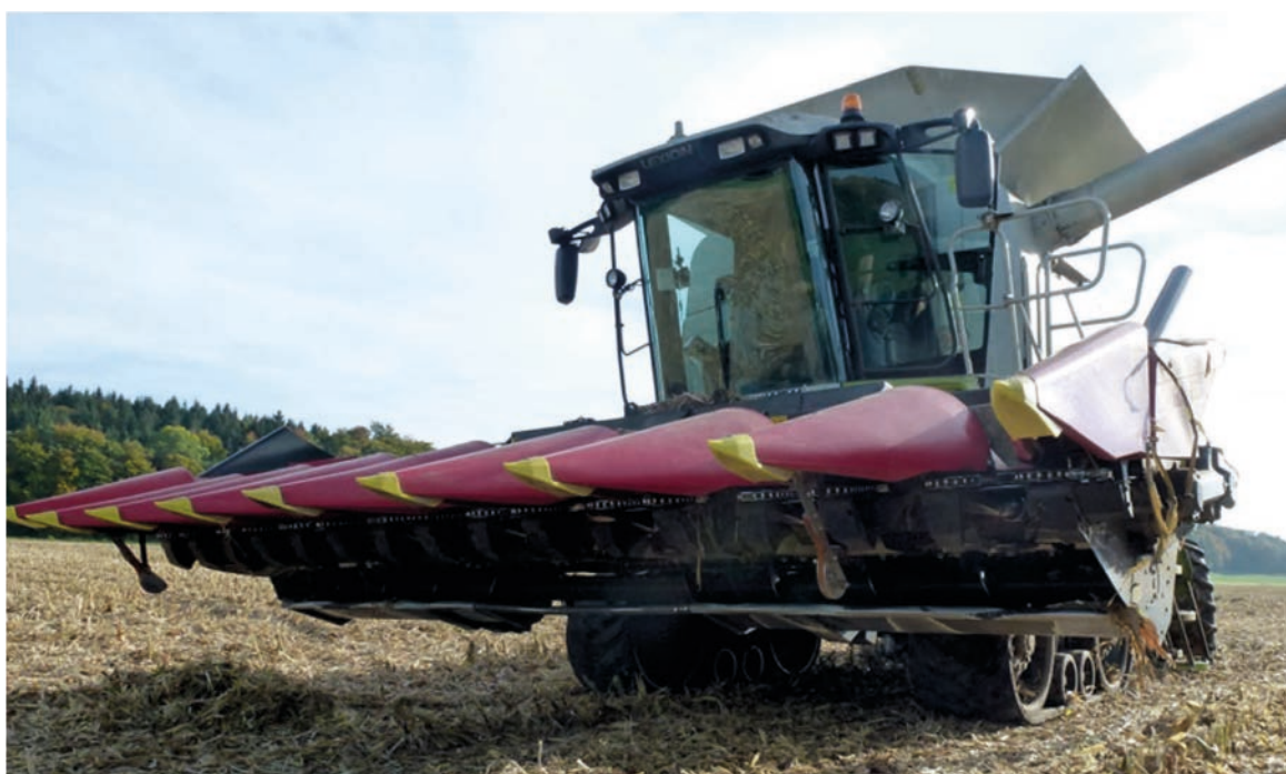
Abb. 2: Maispflückvorsatz Mais Star* Collect mit Schwadvorrichtung
