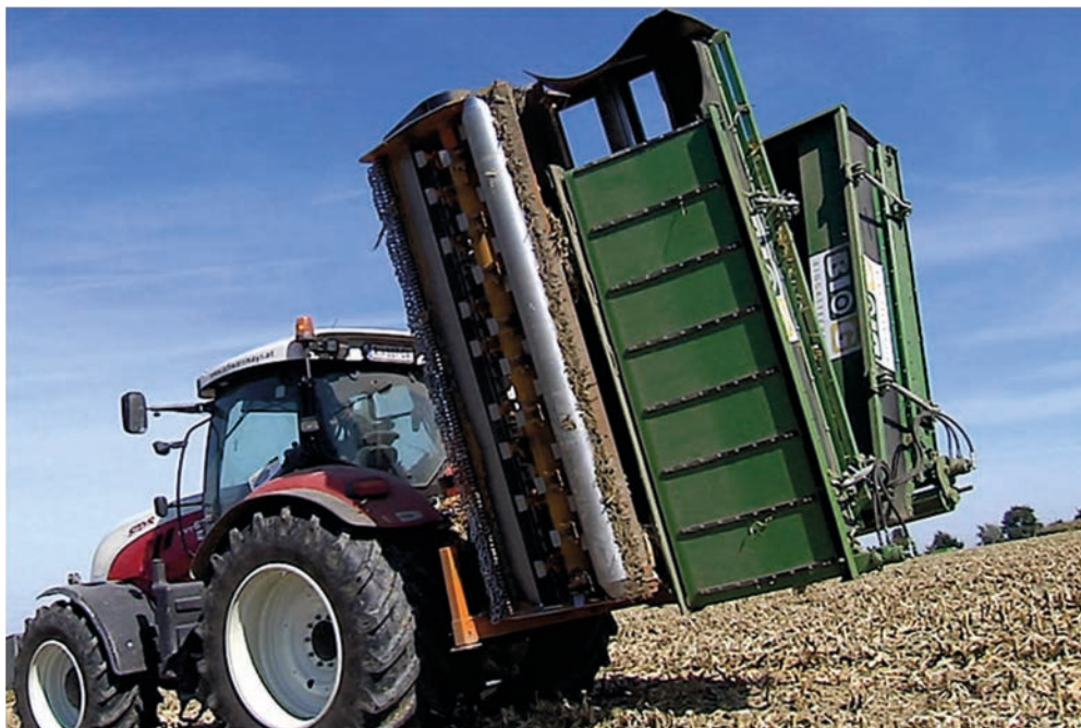
Abb. 3: Schwadmulcher BioChipper mit Querförderbändern
