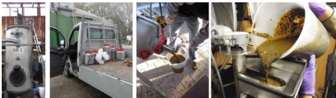
Abb. 7: Inokulum: Abholung und Befüllung der Durchflussversuche
