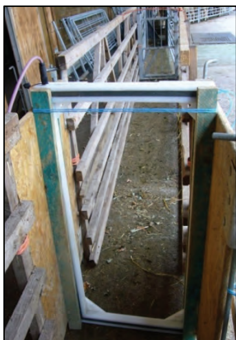
Abb. 4: Durchlaufantenne im Treibgang
