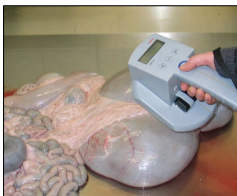
Abb. 5: Überprüfung auf Vorhandensein eines Bolus mittels Handlesegerät
