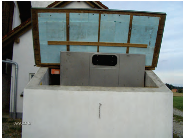
CCM – Anteigbottich – Befüllung mit Schlepper Anmischen auf TS Gehalt 27,5 %
