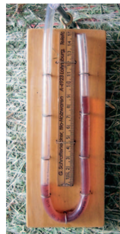
Abb. 23: Messen des statischen Druckes. Ein Schlauchende wird unterhalb des Boxenrostes verlegt; 1 mm Wassersäule entspricht ca. 10 Pa.
