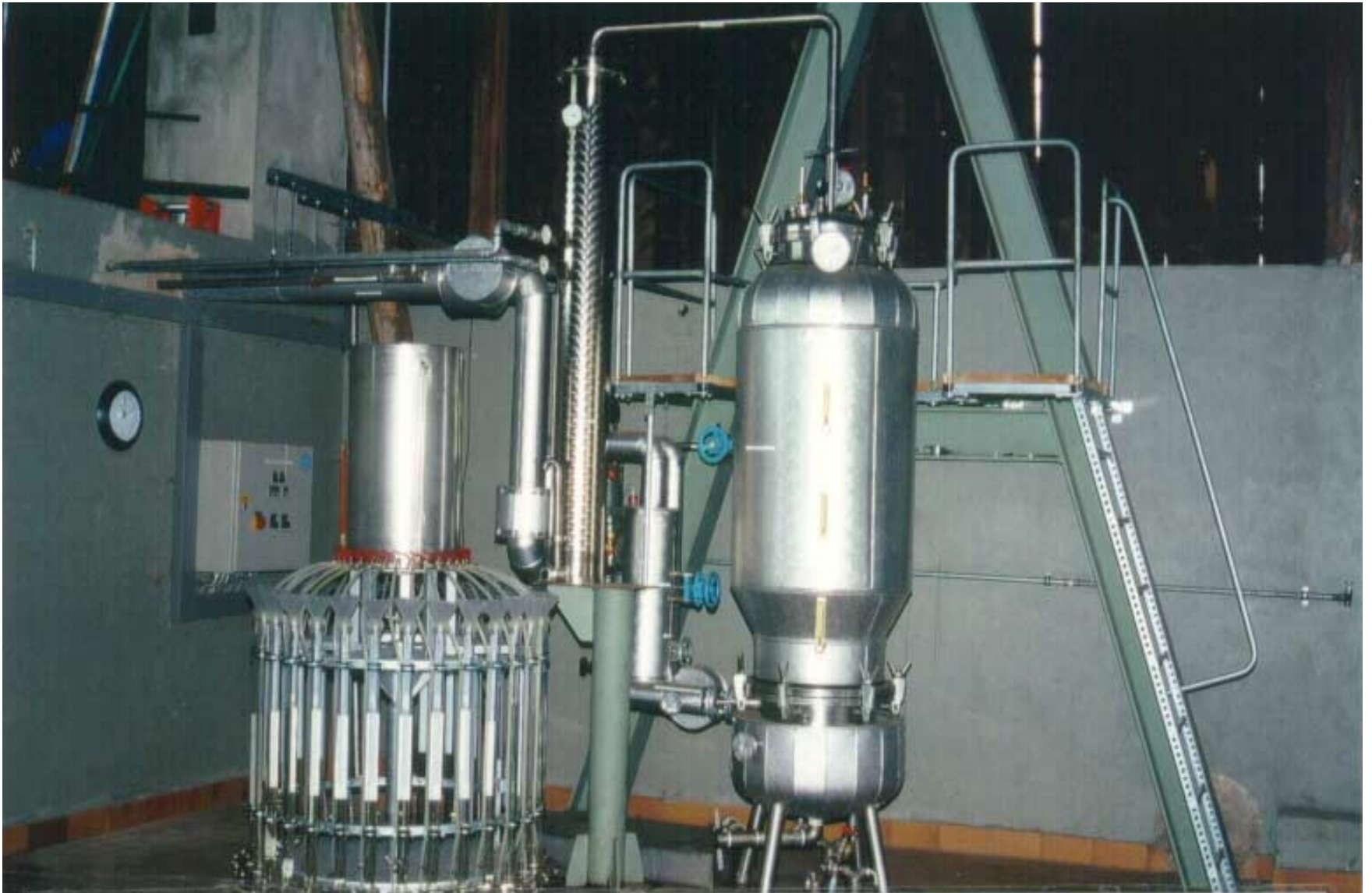
Optimierte Versuchsdestillationsanlage mit karussellförmiger Kondensaterfassung
