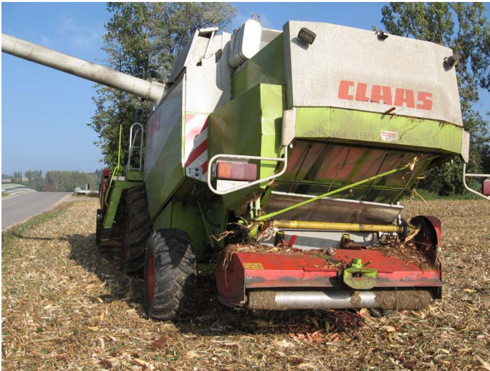
Abbildung 3: An der Hinterachse angebrachtes Mulchgerät
