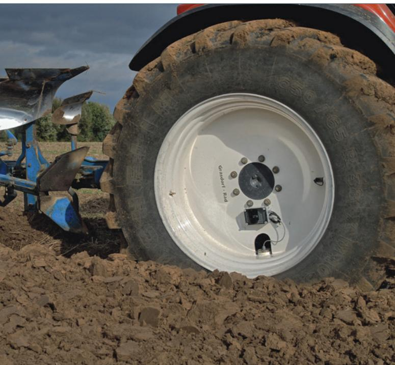
Abb. 2: Ultraschallsensor in der Felge beim Pflügen (Foto: Ortmeier, TI)
