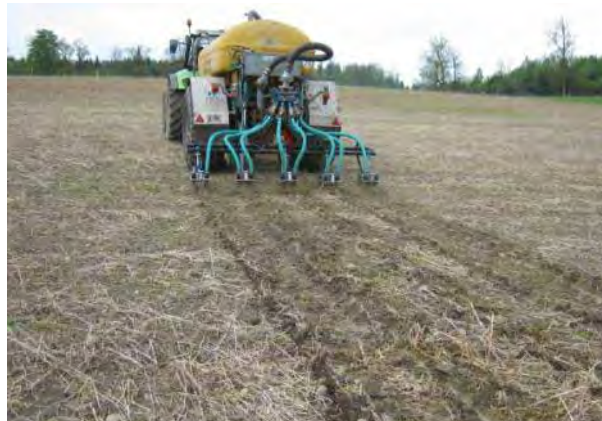
Mulchsaat ohne Saatbettbereitung: Gülle-Schlitzgerät à Mulchsaat
