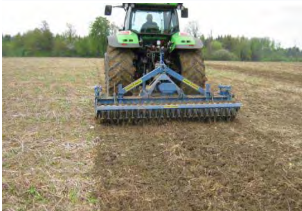
Mulchsaat mit Saatbettbereitung: Gülle Schleppschuh à Kreiselegge à Mulchsaat
