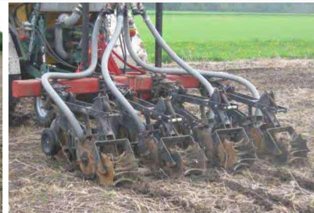
Streifenbodenbearbeitung : Gülleinjektion à Saat in den Streifen
