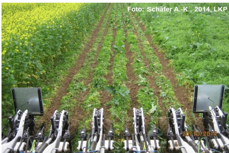
Abb. 2 Technik Streifenbodenbearbeitung (Strip-Tillage) im Herbst
