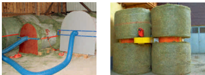
Abb. 11: Links Zentralrohr Trocknung; rechts Kompaktanlage mit vier Zwischenringen.
