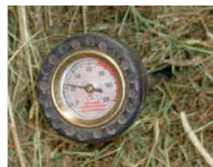
Abb. 22: Links Prüfen des Trocknungszustandes mit Rundstahldorn; rechts Prüfen mit Stechthermometer.
