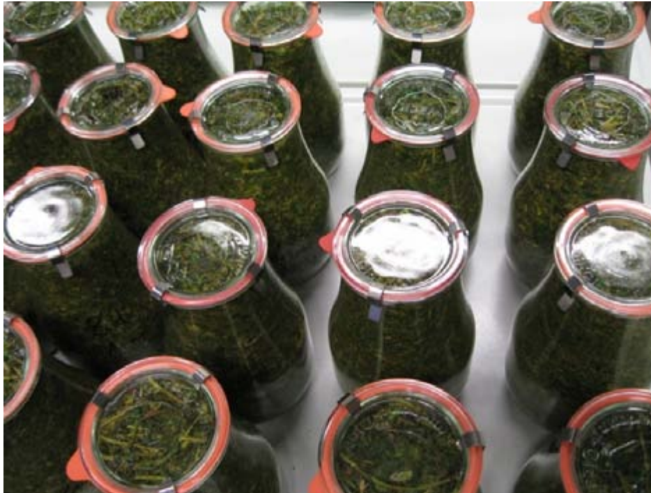
Abb. 3: Weckglas-Silos mit gehäckseltem Pflanzenmaterial
