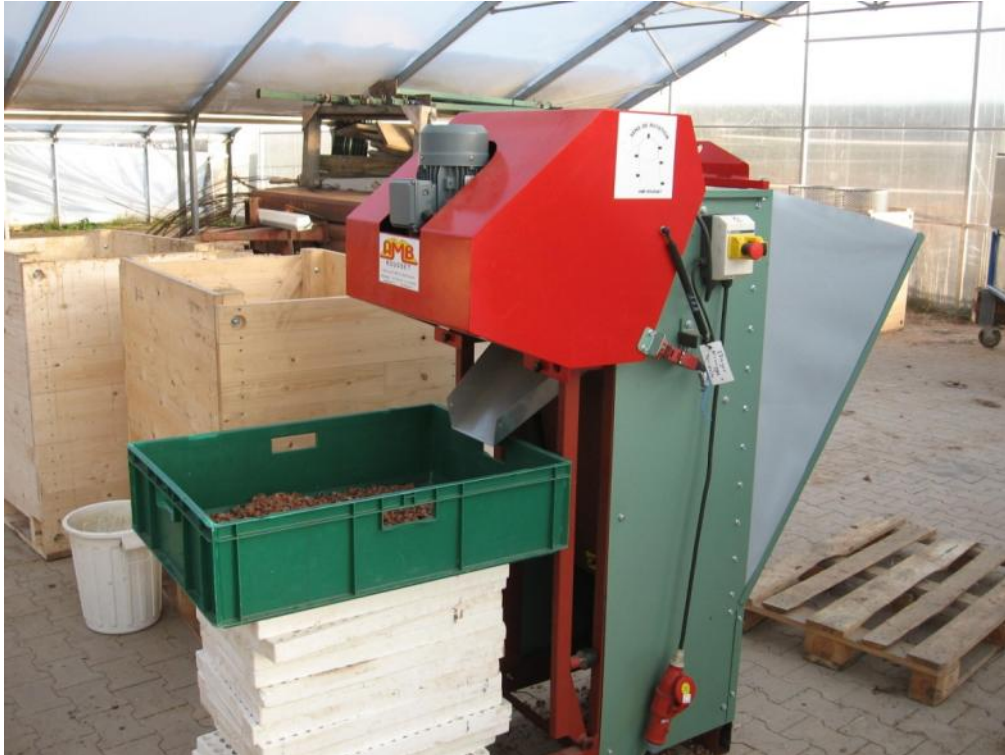
Abbildung 21: Knackmaschine AMB im Einsatz
