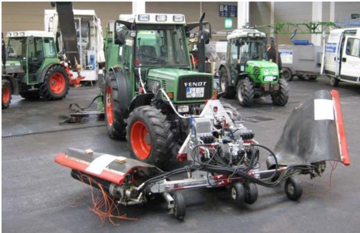
Abbildung 2: Zeilenmulcher „Greenmaster“ (Teil-Eigenkonstruktion Lohnunternehmer Haas)
