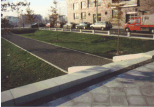
Abb.2: Beispiel einer Entwässerungsmulde Rummelsburger Bucht, Berlin, Foto: IPS
