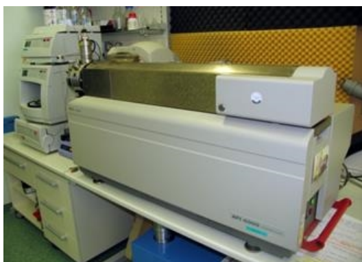
Abb. 3: LC-MS-MS Analysegerät bei der MUVA-Kempton (links) Validierung der Messergebnisse QAV am PC (rechts, Foto: MUVA)
