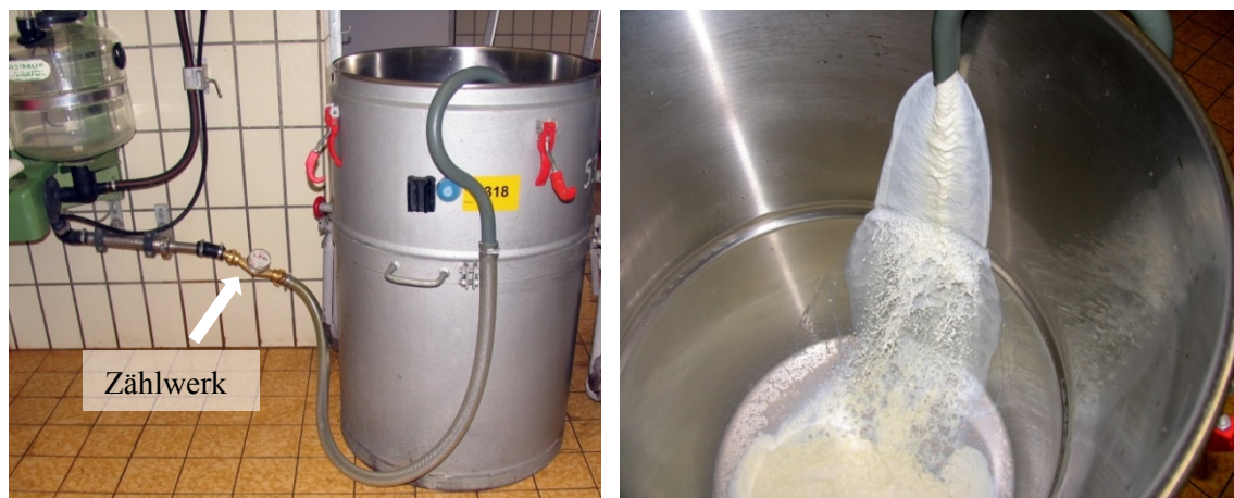
Abb. 18: Versuchsaufbau zur Probenahme Handreinigung Tank (links); Einlaufende Milch in den untersuchten Tank (rechts)
