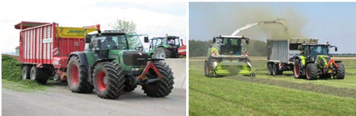
*Ladewagen (links), Häcksler und z. B. ein Abschiebewagen (rechts) können als Einzel- oder kombiniertes Verfahren für die Substraternte von Grünlandflächen eingesetzt werden*
