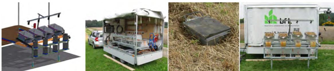
*Digitaler Prototyp des mobilen Regensimulators (links); Prototyp des neu entwickelten Regensimulators im zusammengebauten transportfähigen Zustand (Mitte-links); Modulare Bodenbehälter können leicht zum Ausstechen von Bodenblöcken angepasst werden (Mitte-rechts); Prototyp bei einer Vorführung (rechts)*
