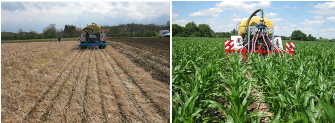
*Gülleausbringung mit Schleppschuhverteiler in Zwischenfrucht-Bestand am 14.4.2014 (links). Gülle-Spätdüngung mit schwerem Doppel-Scheibeninjektor am 1.7.2014 (rechts)*
