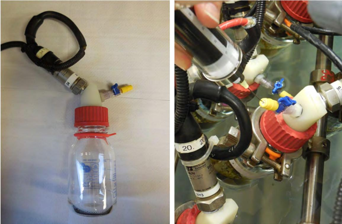
*ATS-System bestehend aus 250 ml Batchflasche mit aufgeschraubtem Absolut-Drucktransmitter sowie Luer-Locksystem und Injektions-Septum (links). Biogas Probenahme mit gasdichter Spritze bei laufendem Versuch (rechts)*
