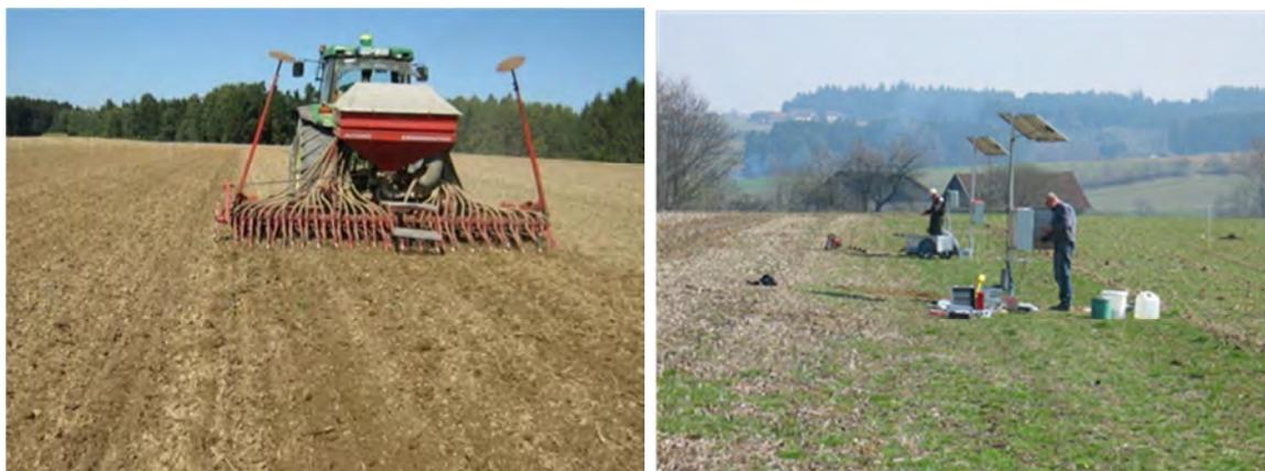
*CTF Versuche mit Systembreite 4,5 m (links) und Bodenfeuchte Messstationen (rechts)*
