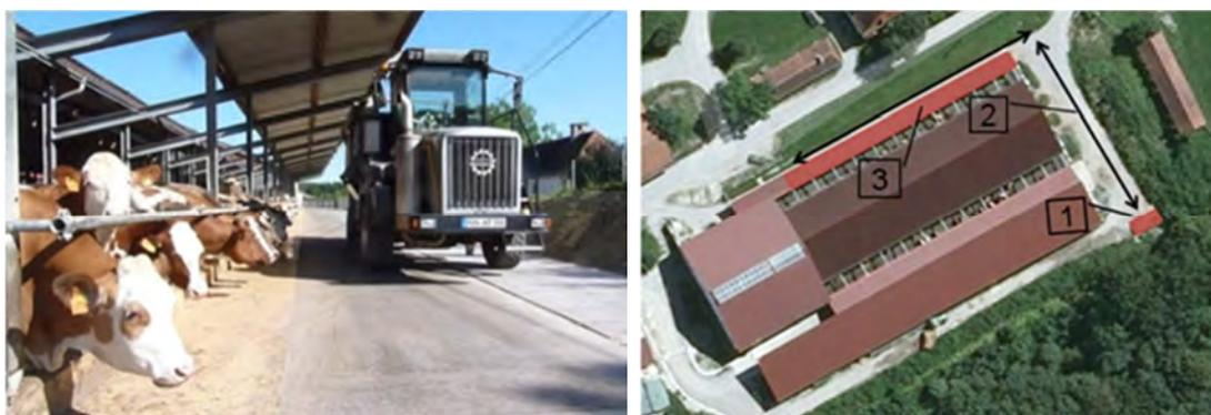
*Selbstfahrer-Futtermischwagen bei der autonomen Fahrt (links) und Routenführung während der Testphase in Achselschwang (rechts), 1=Start; 2=Route; 3=Futtertisch*
