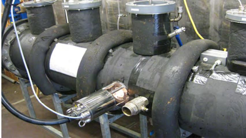
*Eingebauter Nah-Infrarot Sensor (Fa. Bruker) in einen 220 Liter Laborbiogasfermenter des Instituts für Landtechnik und Tierhaltung*
