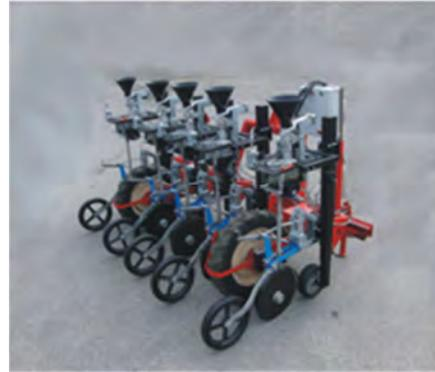
*Virtueller und realer Prototyp der elektrisch angetriebenen Präzisionssämaschine (links und rechts)*
