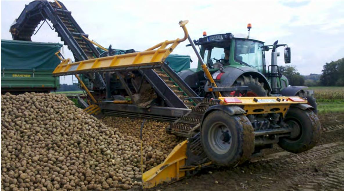
*Versuchseinsatz des am Traktor angebauten Reinigungsladers „Minimaus“ der Firma Brettmeister (Betrieb in Schubfahrt mit Rückfahreinrichtung)*
