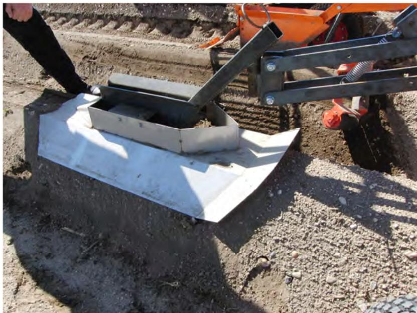
*Test eines neuen Verlegeschar integriert in das Führungsblech*
