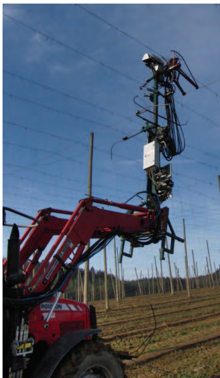
Prototyp beim Aufhängen von Aufleitdrähten in einem Hopfengarten (links); Häufigkeit der Dauer von Zykluszeiten vor (rechts oben) und nach der Optimierung (rechts unten)
