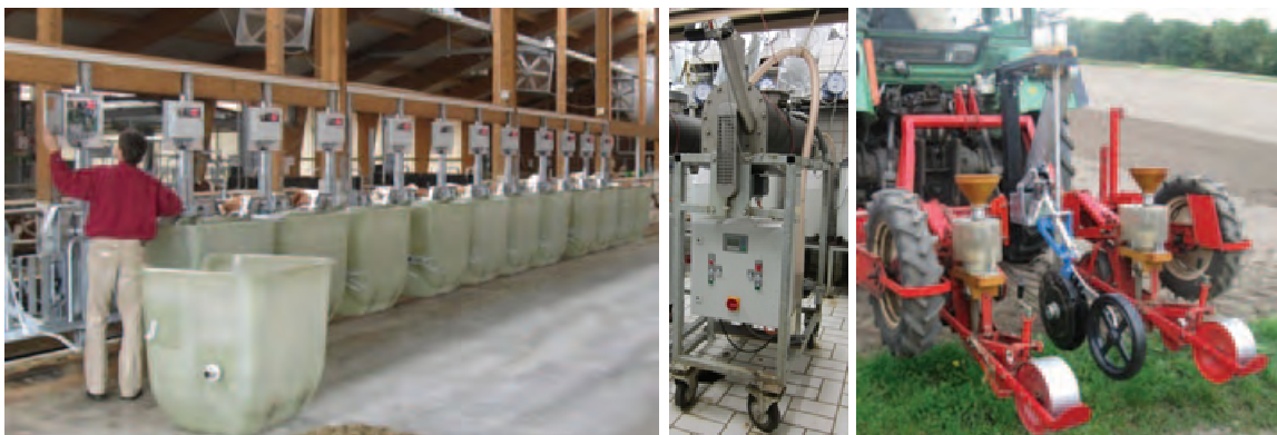
links: Inbetriebnahme der Grundfutterwiegetröge im MGZ Triesdorf; mitte: Versuchsfementer mit autonomer Steuereinheit; rechts: Prototyp eines Einzelkopf-Säaggregates
