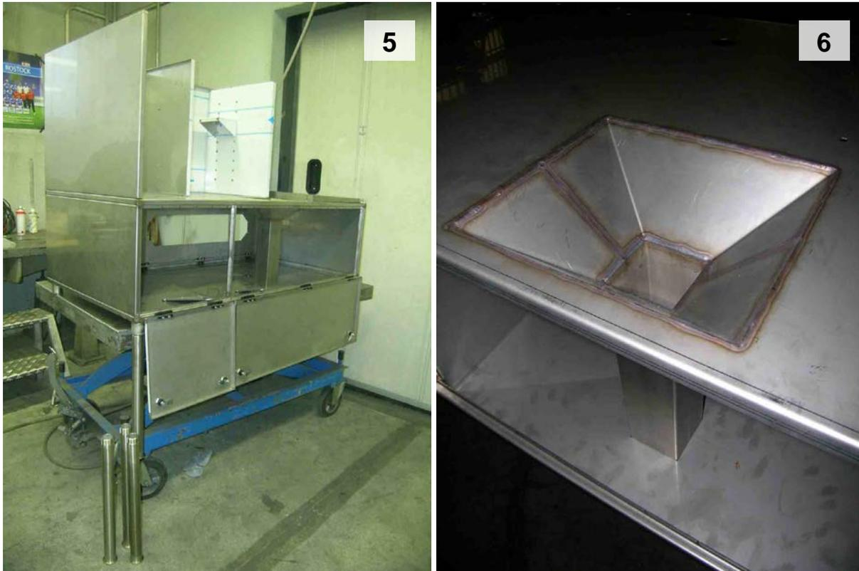
Abb. 5–6: Fertigungsstand der Ei-Waschanlage November 2009, Korpus (5), Durchflusstrichter (6)
