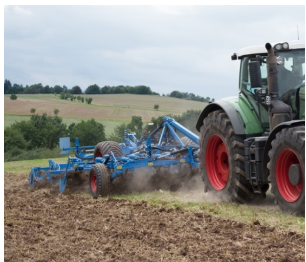
Abb. 5.4: Intensiv arbeitender Stoppelgrubber zur Beseitigung von Ausfallgetreide und neu aufgelaufenen Samenunkräutern (Werkbild, Fa. Lemken)
