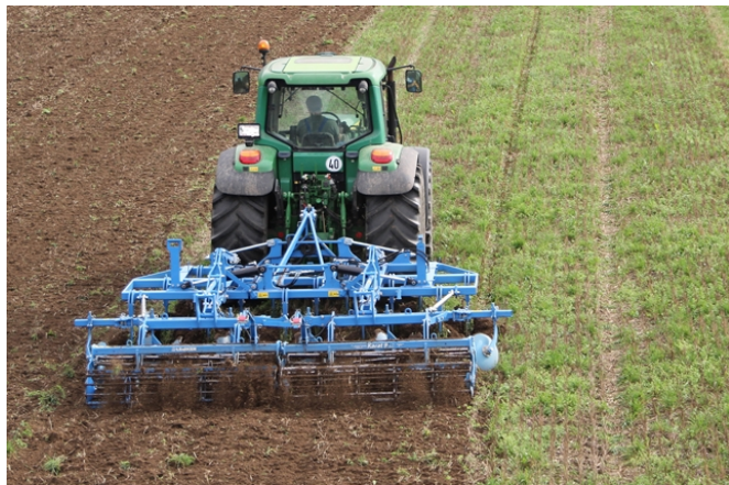
Abb. 5.7: Flache, aber intensive Bodenbearbeitung gegen Acker-Fuchsschwanzkeimpflanzen und Ausfallgetreide (Werkbild, Fa. Lemken)
