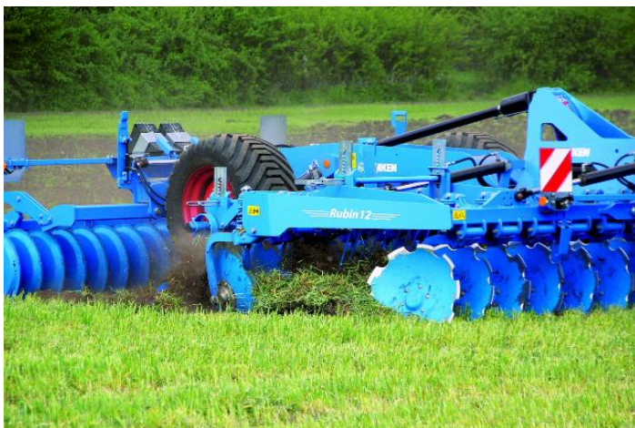
Abb.5.10: Auf ebenen, nicht erosionsgefährdeten Standorten kann eine notwendige Grünlanderneuerung auch durch intensive Bodenbearbeitung erfolgen (Werkbild, Fa. Lemken)
