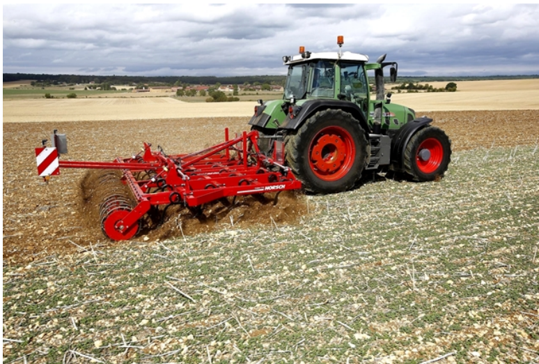
Abb. 5.3: Die mechanische Beseitigung von Ausfallraps sollte möglichst flach erfolgen (Werkbild, Fa. Horsch)
