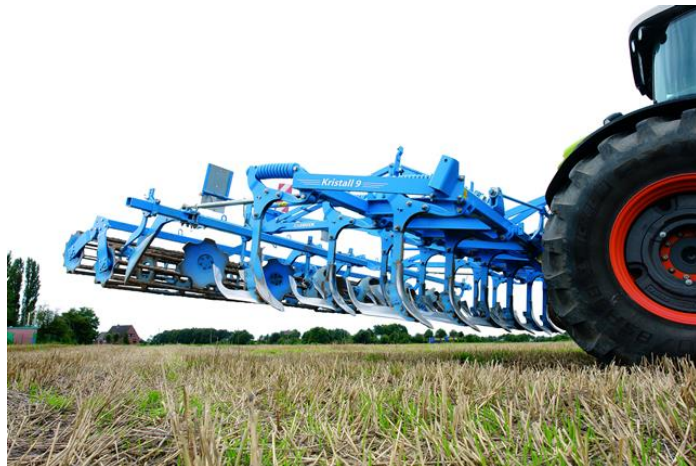
Abb. 5.2: Ganzflächig schneidender und tief arbeitender Grubber zur Bekämpfung von Wurzelunkräutern nach der Ernte (Werkbild, Fa. Lemken)
