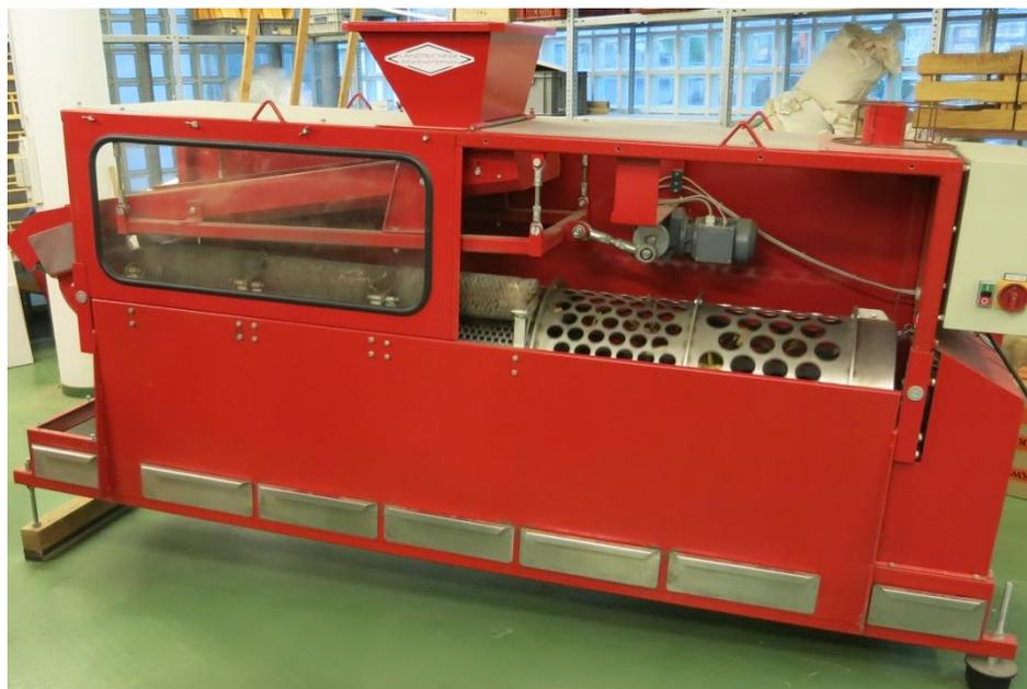
Abbildung 24: Trommelsiebmaschine mit 6 Größenklassen
