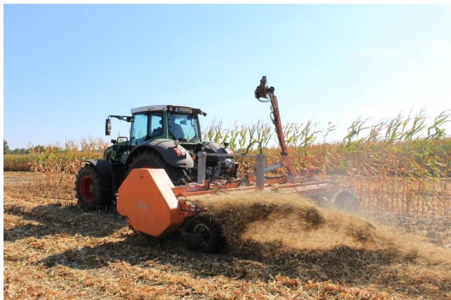
*Abbildung 15: Einsatz des Schwadhäckslers UP-6400 (Prototyp) (Versuchsjahr 2015)*
