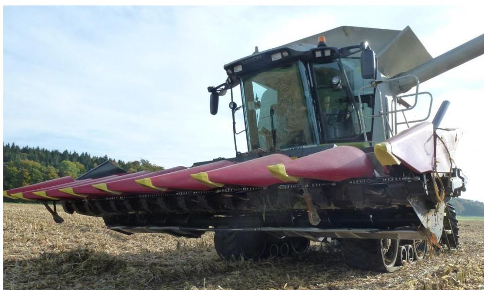
*Abbildung 20: Detailfoto vom Unterbau des Mais Star\* Collect*
