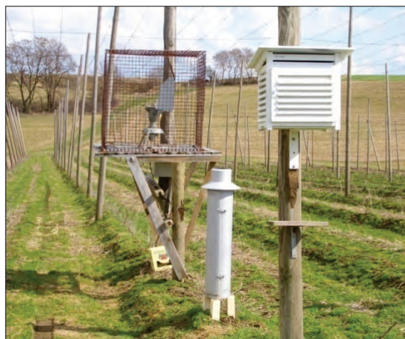
Abb. 8: Sporenfalle im Hopfengarten zur Ermittlung der Zoosporangienzahl, vorne im Bild die Wetterstation
