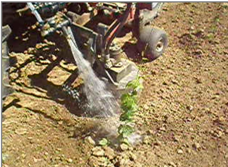
Abb. 1: Hopfenkreiseln u. sensorgesteuerte Einzelpflanzenbehandlung in einem Arbeitsgang
