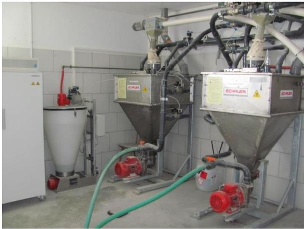
Abb. 1: Flüssigfutterbehälter mit Kleinmengendosierer (links)
