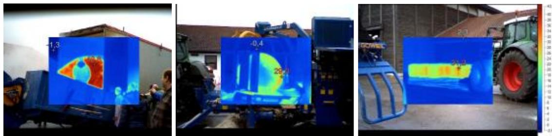
Abb.: Thermografische Aufnahmen der Pressschnitzel bei der Anlieferung, dem Pressen von Rundballen und deren Lagerung (von links)
