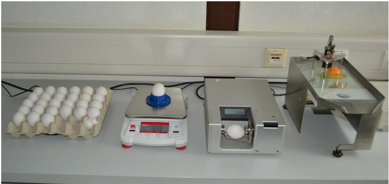
Abb. 9: Messstrecke zur Erfassung der Eiqualitätsparameter: Eigewicht, Bruchfestigkeit, Eiklarhöhe
