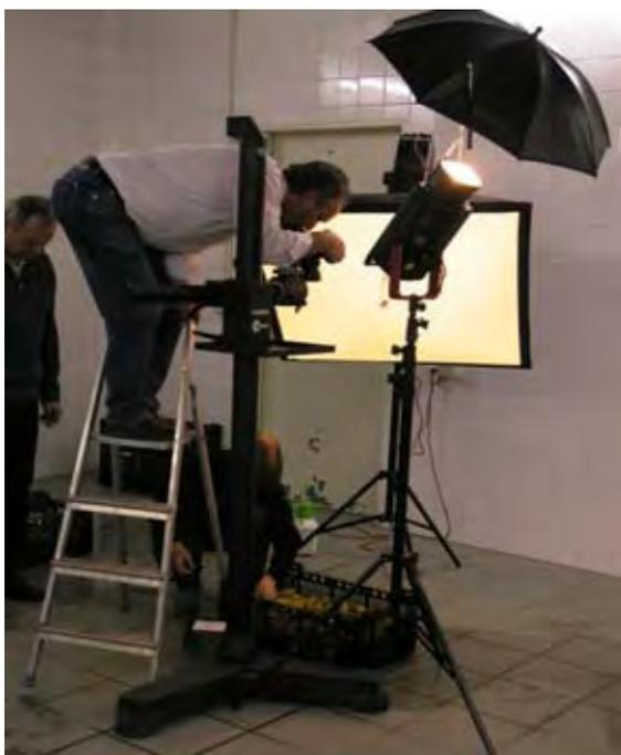
Bild 1: Versuchsanstellung zur fotografischen Dokumentation in einem tageslichtfreien Raum mit optimierter Beleuchtung und professionellem Stativ
