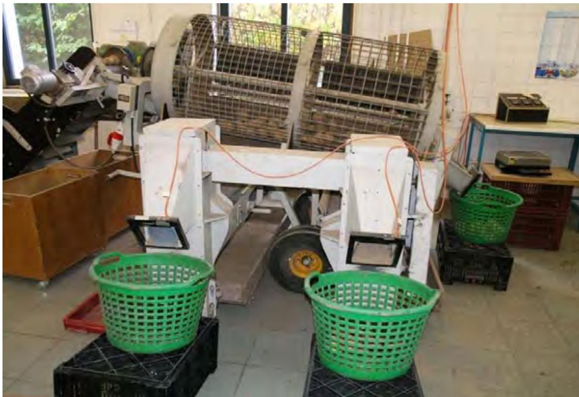
Bild 3: Kalibrierung der Partie: Größen bis 35 mm; 35-55 mm und größer als 35 mm Querdurchmesser.
