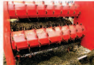
Fräsrollen für Silageblöcke im Vorratsbehälter
