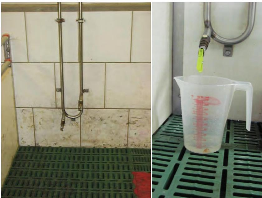
**Abb. 3: Überprüfung des Wassernachlaufes im „Normalbetrieb“ - – „Öffnen“ der Nippel mit Wäscheklammern**
