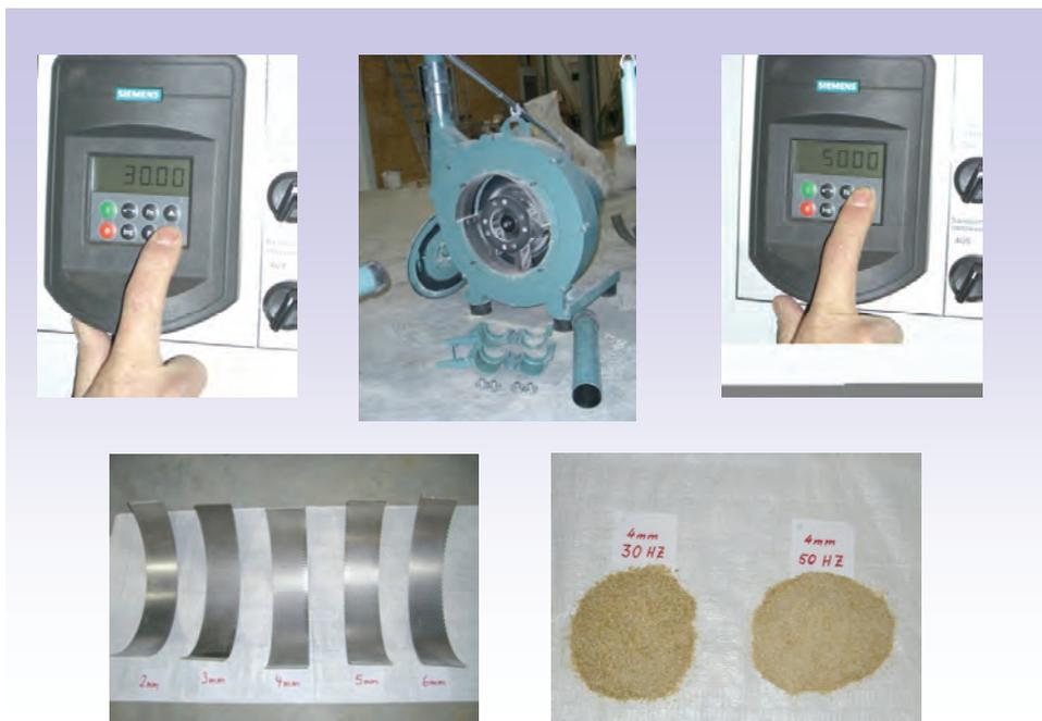
**Abb. 1: Hammermühle in Schwarzenau (11 kW) mit Wechselsieben und Frequenzumrichter**
