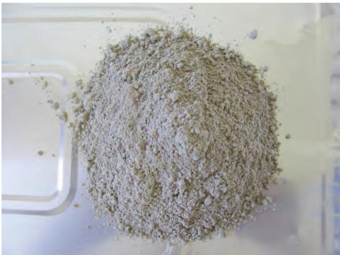
**Abb. 3: Diamol zur Wasserbindung**
