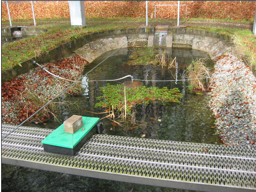
Abb. 4: Biotank, wenige Wochen nach Versuchsbeginn (noch ohne Vogelschutz und Beschattungsmatte, zweiter Futterautomat außerhalb des Bildausschnitts, Lufteintragsgerät inaktiv)
