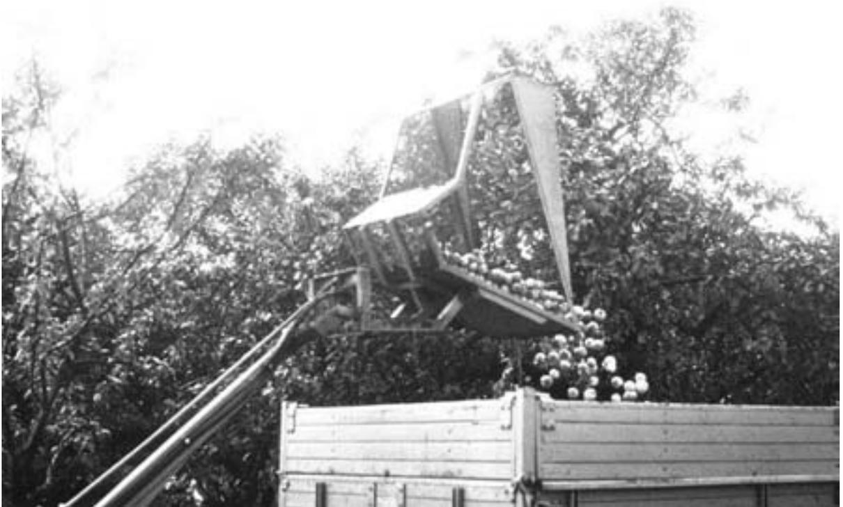
Bild 7: Die selbstfahrende Obstaflesemaschine SF 1000 von Krauß
