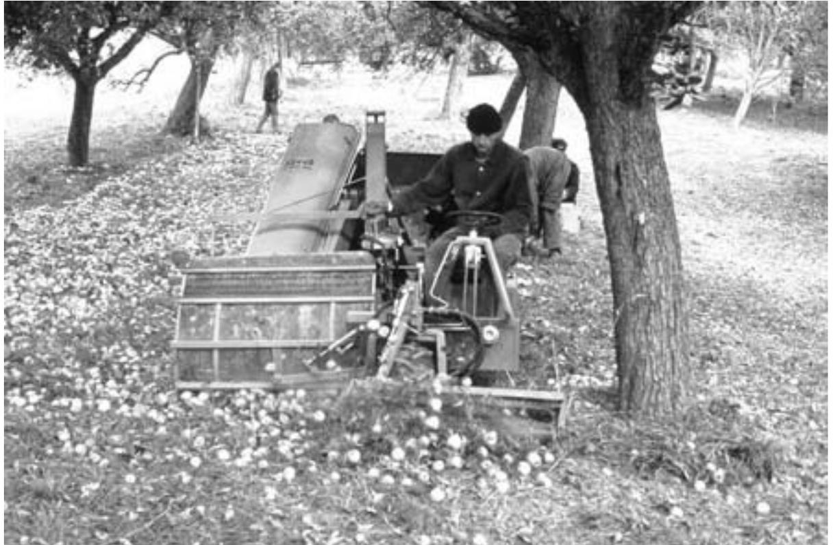
Bild 6: Die OB 80 H ermöglicht eine maschinelle Hochentleerung auf einen Hänger
