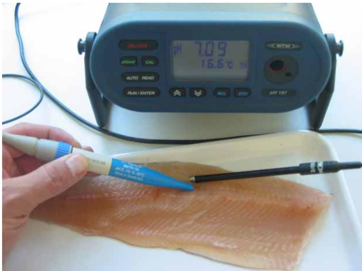
**Abbildung 13: pH-Wert-Messung am Fischfilet (links: pH-Einstichelektrode, rechts: Temperaturfühler)**
