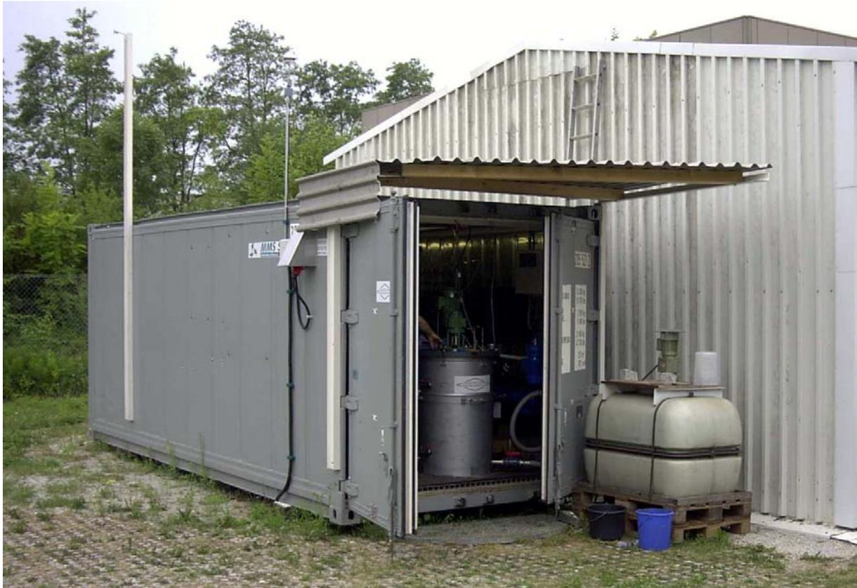
Abbildung 8: Foto der Modell-Biogasanlage mit Vorlagebehälter auf dem Außengelände von TUM-SWW
