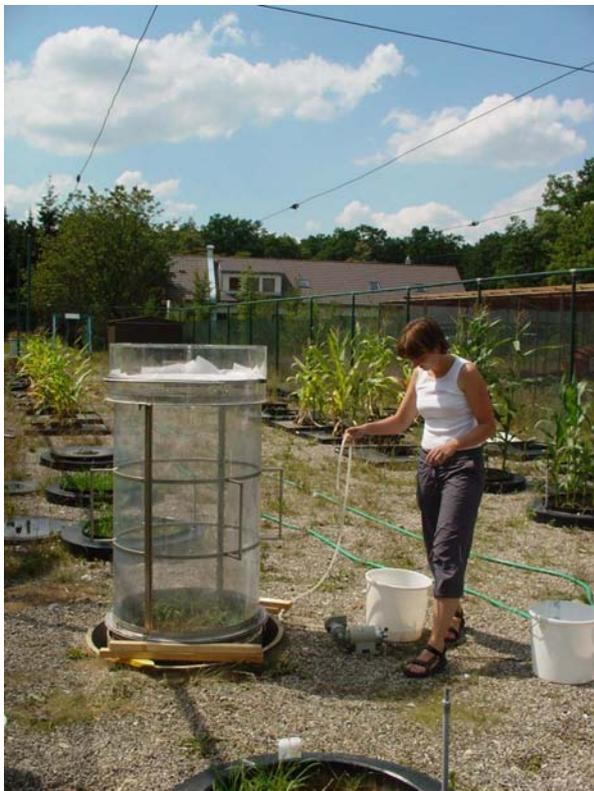
Abbildung 92: Beregnungseinrichtung über einem Lysimeter zur Beregnung
