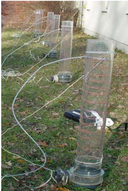
Abbildung 90: Untersuchungen gasförmiger N-Emissionen aus Roh- und Biogasgülle mit offenen Küvetten
