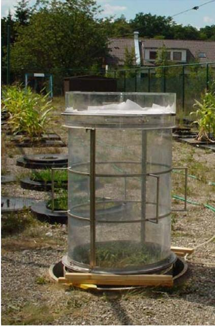
Abbildung 87: Beregnungskammer über einem Grünlandlysimeter
