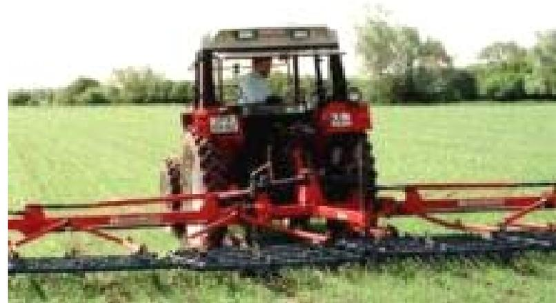
Die Prüfung der Hackgeräte, solo oder in Kombination mit einem Striegelinsatz und des Bürstengerätes, zeigte einen ebenfalls deutlichen Abstand in der Bekämpfungsleistung gegenüber der chemischen Unkrautbekämpfung. Die Bürstenbehandlung war durch die Kulturschädigung zusätzlich in der Ertragsbildung beeinträchtigt
