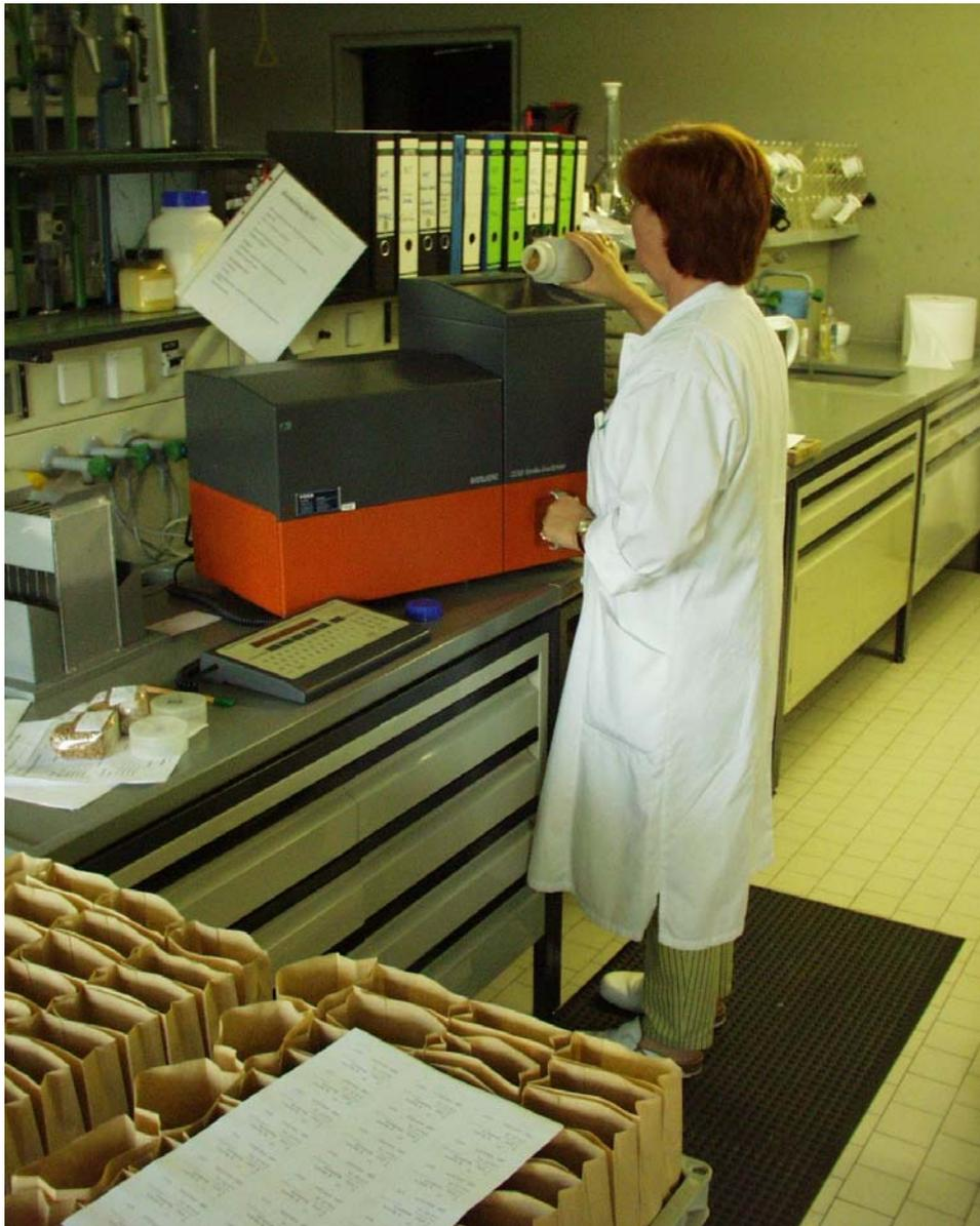
Abb. 5: Nah-Infrarot-Transmissionsspektroskopie (NIT) für Brauqualitätsbestimmungen
