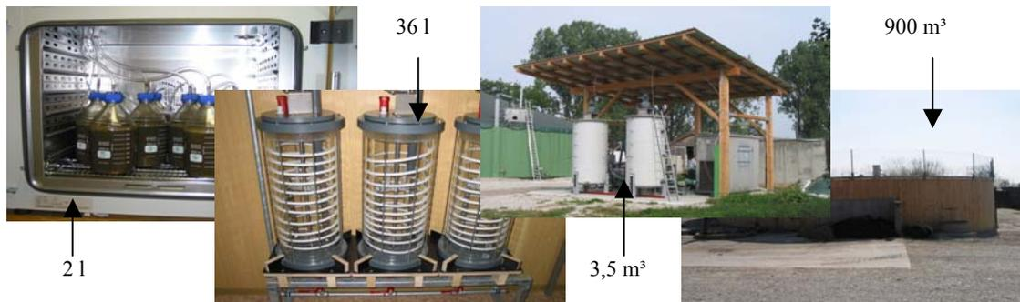
Entwickelte Versuchsfermenter im Rahmen des Projektes
