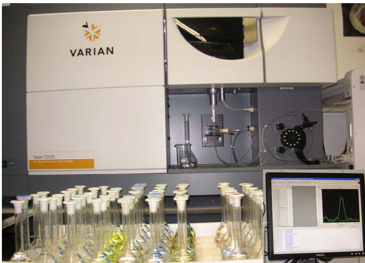
Abb. 11: Königswasserauflösungen zur Elementaranalyse mittels ICP-OES
