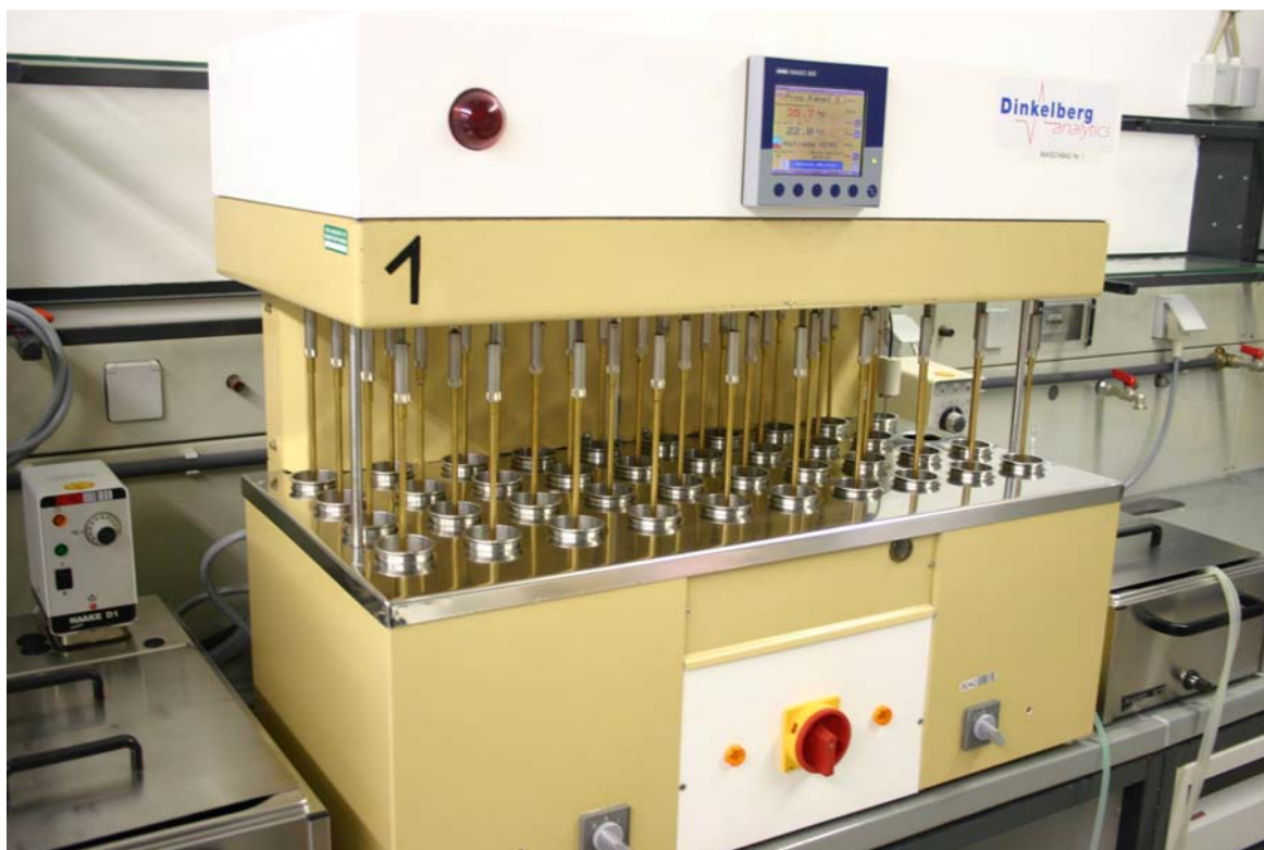
Abb. 16: Die neu umgebauten Maischbäder des Jahres 2007. Eine vollkommen neue Steuerelektronik und die Überwachung des Maischprozesses verbessern die Qualität der Brauwertuntersuchungen
