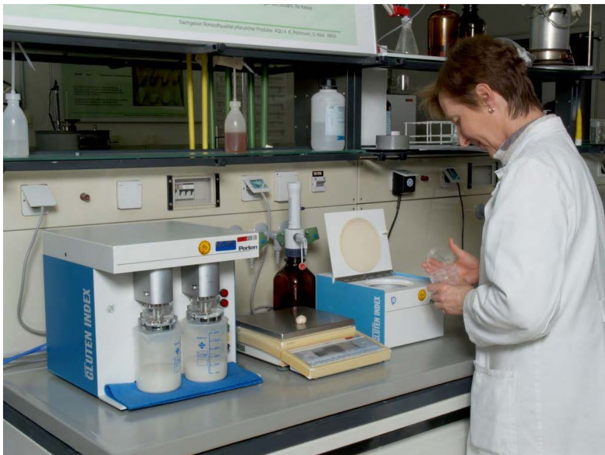
Abb. 7: Messung des Feuchtklebergehaltes und des Glutenindex mit Hilfe des „Gluto-matic-Gluten Index“ Verfahrens
