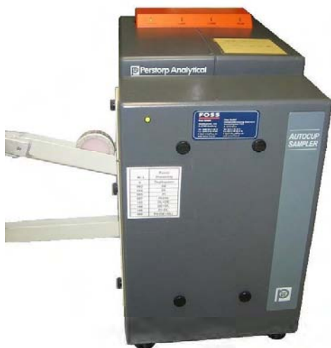
Abb. 23: NIR Systems 6500: Monochromatorgerät der Fa. Foss zur Fleischuntersuchung
