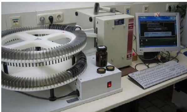
Abb. 21: NIR Systems 6500: Monochromatorgerät der Fa. Foss zur Futtermitteluntersuchung (mit Probengeber)
