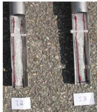
32 L Durchflussfermenter (links) In-sacco-fixierter, dotierter Zeolith wird am Keimträgerrohr befestigt im Fermenter exponiert (rechts)
