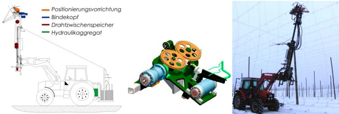
*Teilsysteme (links); Optimierter virtueller Prototyp (mitte); Prototyp beim Aufhängen von Aufleitdrähten in einem Hopfengarten (rechts)*
