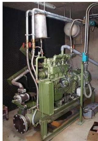
*Belarus Gasmotor Pilotanlage 5*
