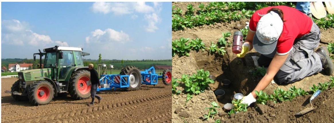
*Setzen der Belastung in Parzellenversuchen mit dem Belastungswagen (links) und Stechzylindernahme zur Analyse der Bodenkennwerte (rechts)*
