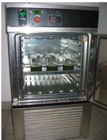
Kühlbrutschrank zur Temperierung der Pflanzensaftaufgüsse
