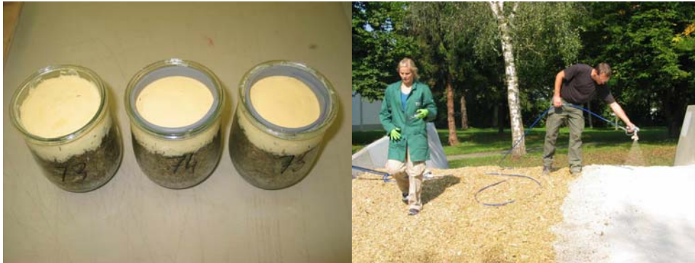
Weckglasversuch mit gegossenem Schaum (links), Aufsprühen des Schaums beim Silover-such (rechts)
