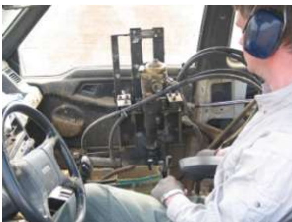
Hydraulischer Bohrstock zur Probenahme von Bodenproben
