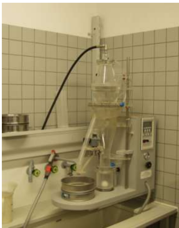
Pollähne-Kanne zur Extraktion von Zysten aus Bodenproben
