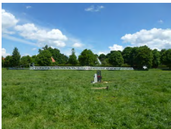
Testapparat zur Bestimmung der dynamischen Positionsgenauigkeit der Ortungssysteme und GPS-Datenlogger der Firmen Libify, ML-C, Hotsure, Telespor und Qstarz auf der Versuchsstation der LfL in Grub
