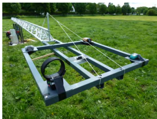
Testapparat zur Bestimmung der dynamischen Positionsgenauigkeit der Ortungssysteme und GPS-Datenlogger der Firmen Libify, ML-C, Hotsure, Telespor und Qstarz auf der Versuchsstation der LfL in Grub
