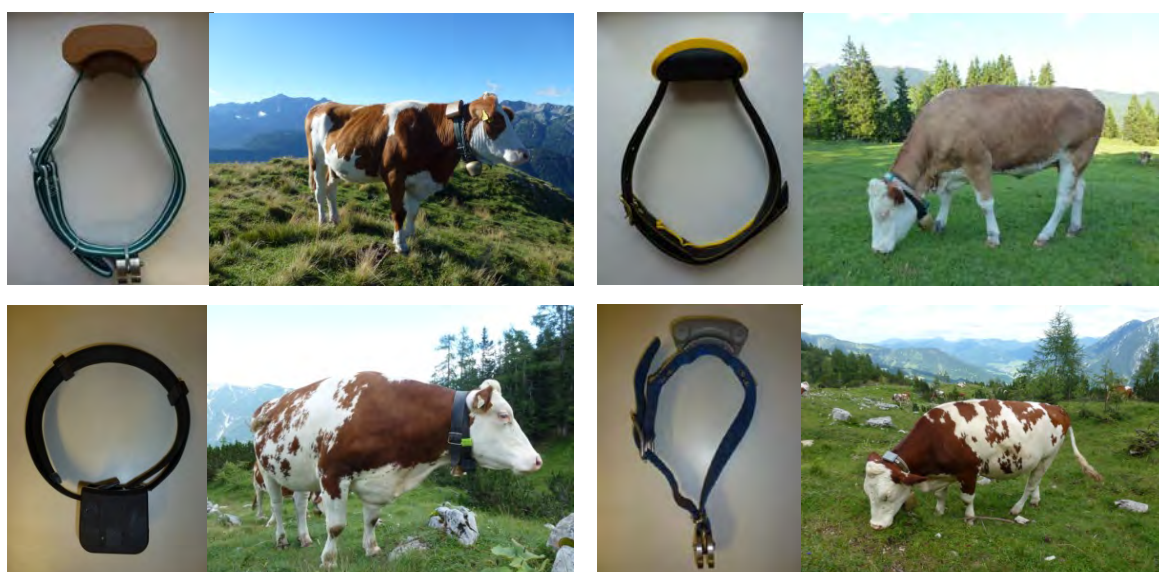
GPS-GSM Ortungssysteme der getesteten Firmen (von links oben nach rechts unten) Libify (mit Gegengewicht), ML-C, Hotsure und Telespor (mit Gegengewicht).
