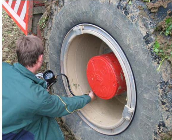
Abb. 3: Die Einstellung eines möglichst geringen Reifeninnendruckes für die tatsächlich benötigte Reifentragfähigkeit entsprechend der Luftdrucktabelle ergibt die größtmögliche Aufstandsfläche.
