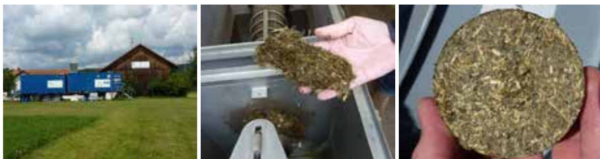
Abb. 1-3: Die mobile Bioenergieanlage an der Versuchsstelle Steinach (links), Silage nach dem Abpressen von Wasser (Mitte) und das speicherbare Endprodukt (rechts)
