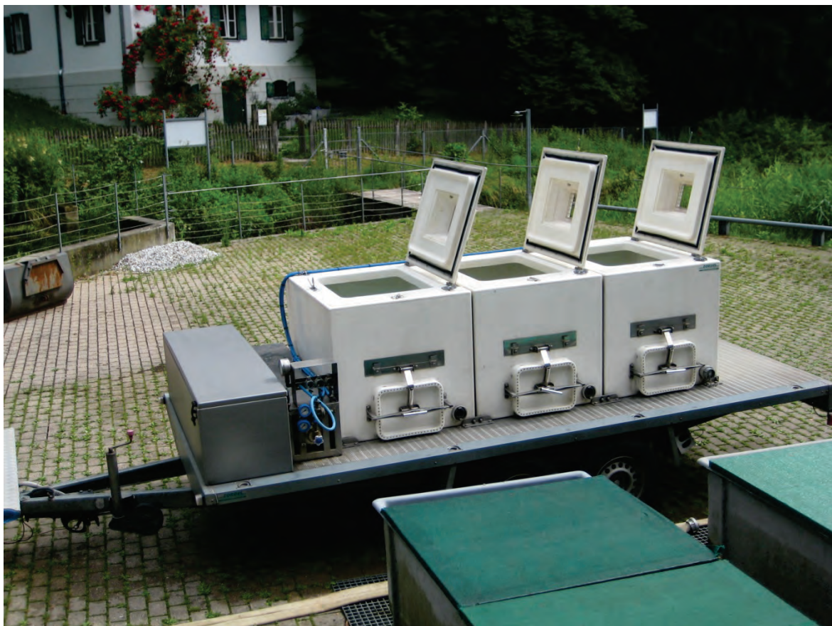
Abb. 2: Anhänger mit 3 Transportbehältern mit installierter Sauerstoffzufuhr und Fischschleusen
