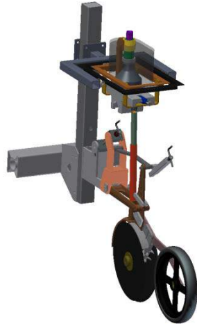
Digitaler Prototyp des Säaggregats (links); Vergleichstest des Säaggregates mit der herkömmlichen Technik (rechts oben); Testergebnisse (rechts unten)
