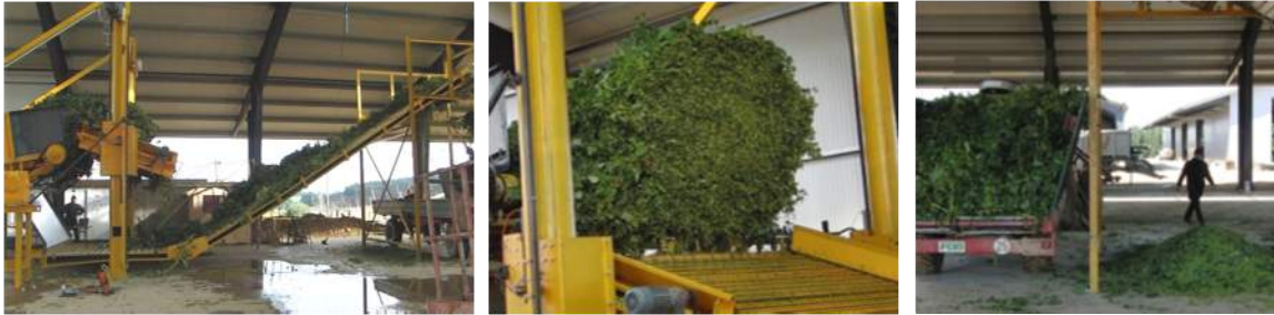
Prototyp der Maschine für die automatische Hopfenpflücke (links); Schneidvorrichtung (mitte); Ergebnisse der Vorpflücke (rechts)
