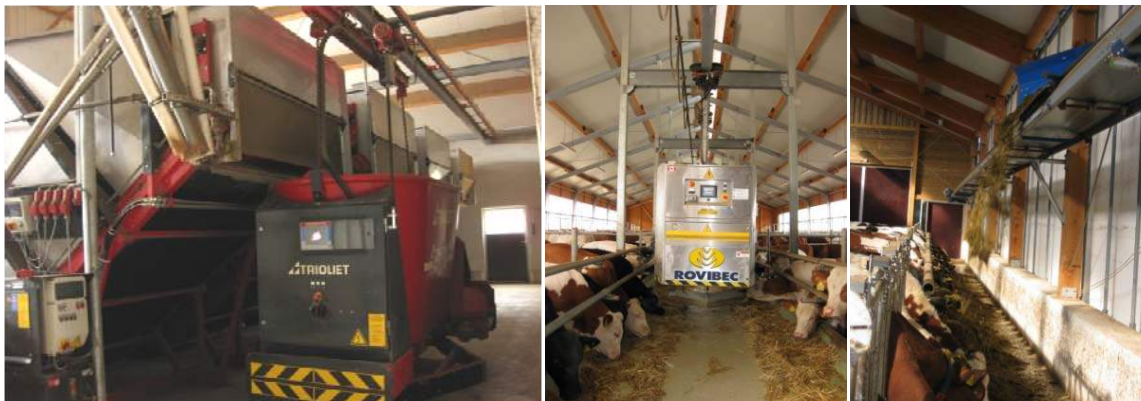
Befüllen eines Misch- und Verteilwagens über Vorratsbehälter (links), schienengeführter Misch- und Verteilwagen (Mitte), Bandfütterung (rechts)
