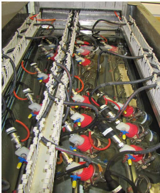
ATS-Test-Messsystem im Wasserbad
