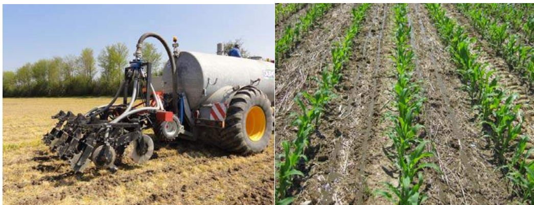
Gülleapplikation kombiniert mit der Streifenbodenbearbeitung (links), Güllespätdüngung mit Schleppschuhen (rechts)
