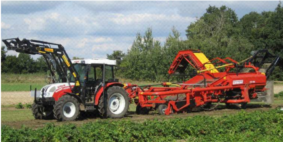
Baldrianwurzelrodesystem mit Überladeband und ausgeklapptem Siebsterne
