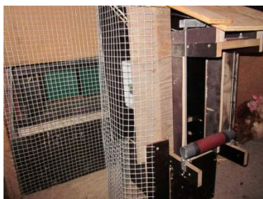
Verwiegen von Legehennen auf einer Wiegesitzstange beim Betreten und Verlassen eines Gruppennestes
