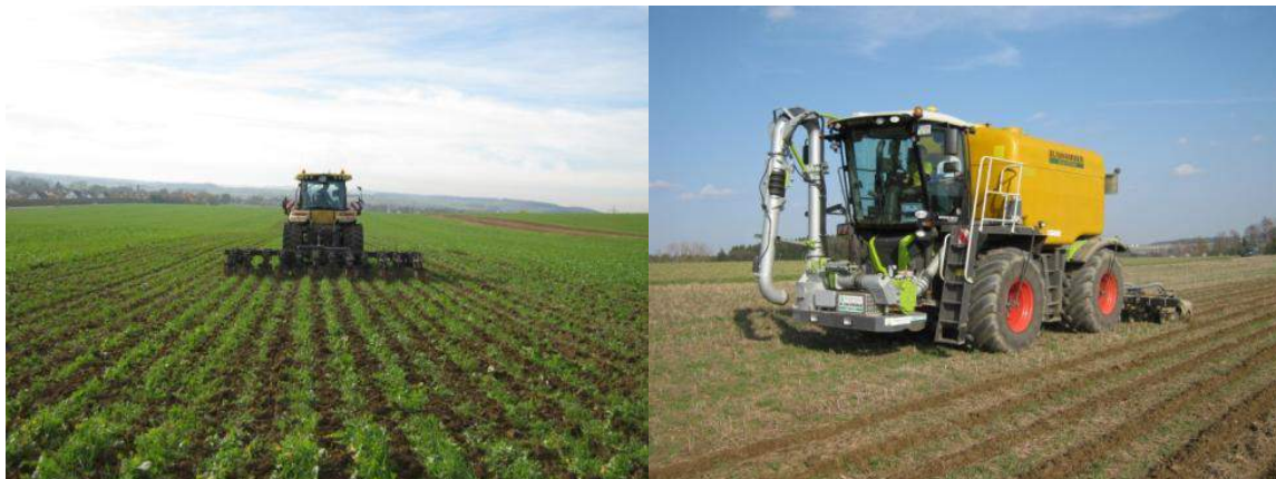
Streifenbearbeitung zu Zuckerrüben im Herbst (links) und zu Mais mit Gülleapplikation (rechts)
