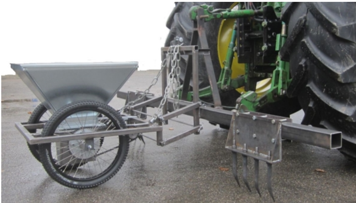
Markierungswagen zur Kennzeichnung von Versuchsflächen als Schlepperanbaugerät
