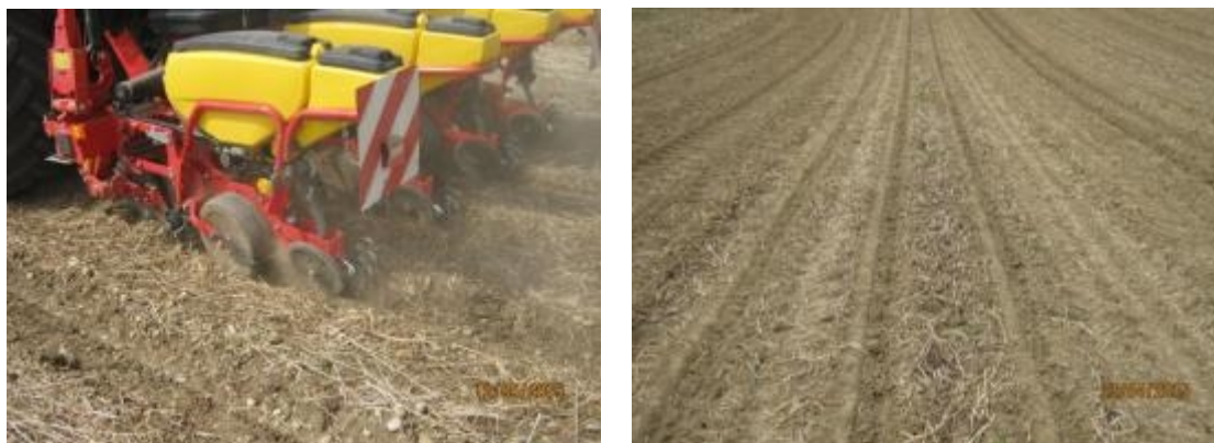
Einzelkornsägergerät mit Zusatzwerkzeugen (Räumsterne, Schneidscheibe, strukturierte Andruckrolle) (links); Mulchsaat Mais ohne Saatbettbereitung (etwa 30 % Bodenbedeckung) (rechts)
