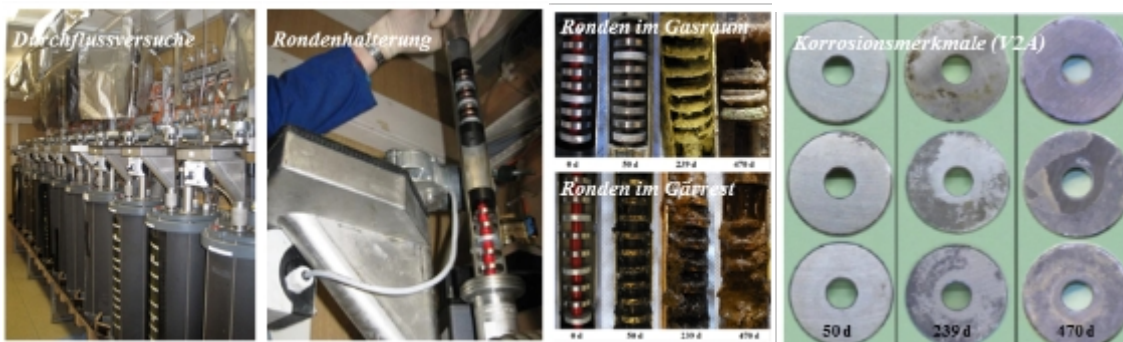
Versuchsdurchführung im Projekt, Bildreihenfolge von links nach rechts: 1-stufige Durchflussversuche, Rondenthalterung im Fermenter für die ausgewählten Werkstoffproben, Zustandsentwicklung der Rondengruppe im Reaktor und Korrosionserscheinung bei der Rondengruppe V2A im Gasraum
