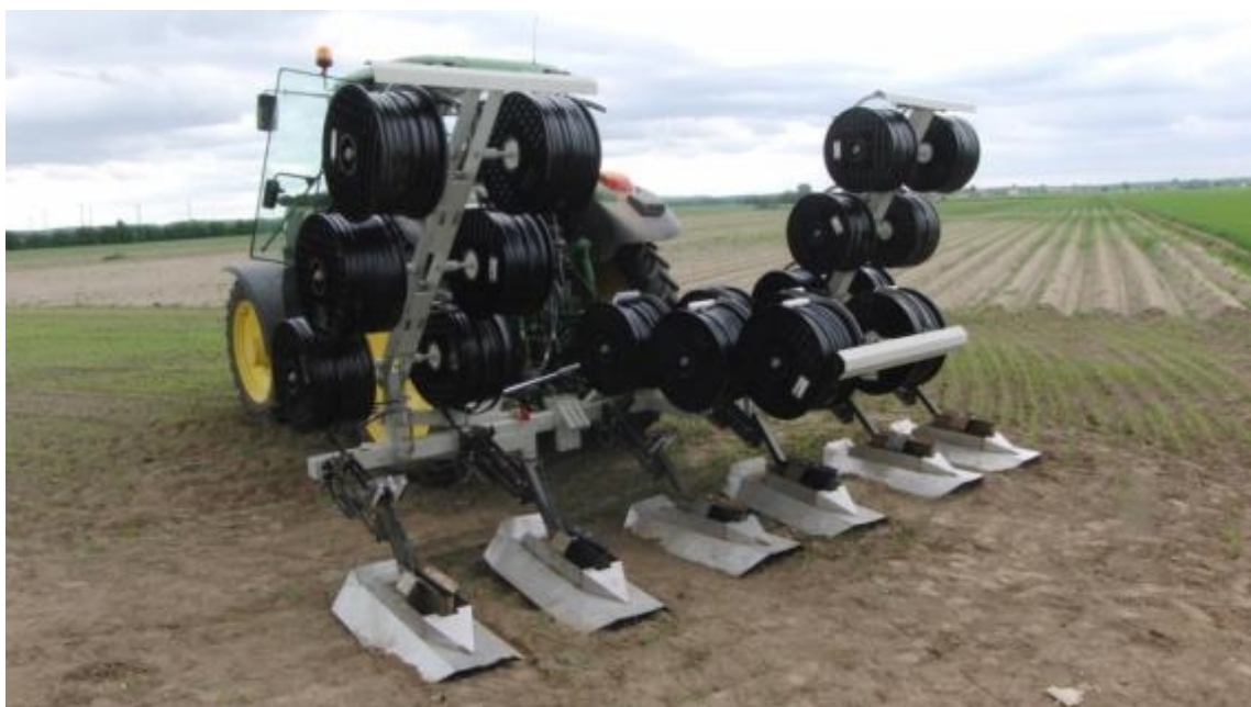
Prototyp eines 6-reihigen Verlegegerätes für Tropfschläuche mit hydraulisch absenkbaren Magazinhaltern
