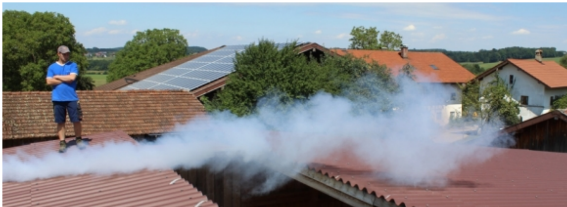
Nebelversuch bei einer mehrhäusigen Stallanlage mit integriertem Laufhof
