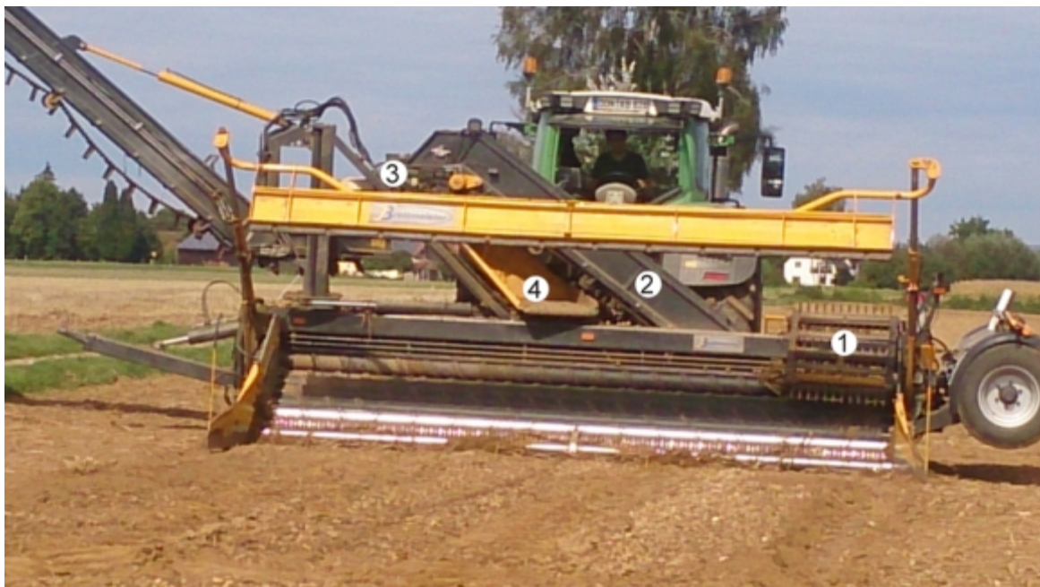
Reinigungslader „Minimaus“ in der Ausführung für die Kampagne 2015: (1) Einzugsband, (2) Auftragsband, (3) Cleaner mit zusätzlichen (4) Rückführband
