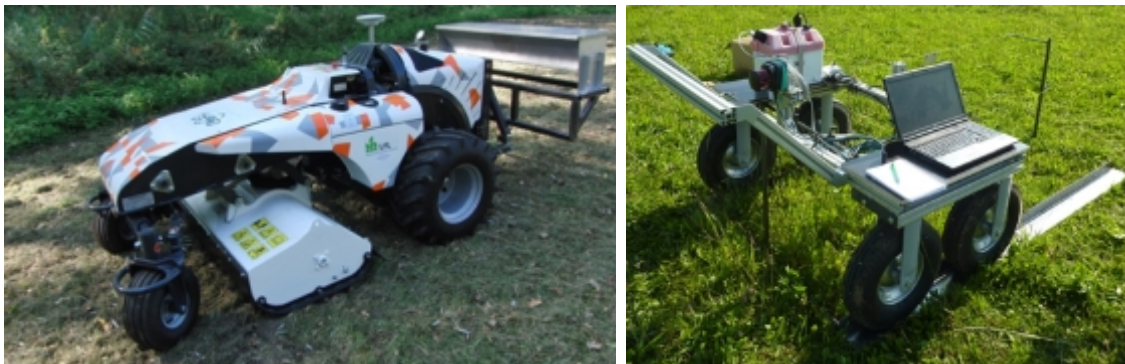
i-LEED Weideroboter für autonome Weidepflegemaßnahmen und Datenerfassung (links); Messapparatur zur Ermittlung von Bewuchsdaten auf einer Kuhweide (rechts)
