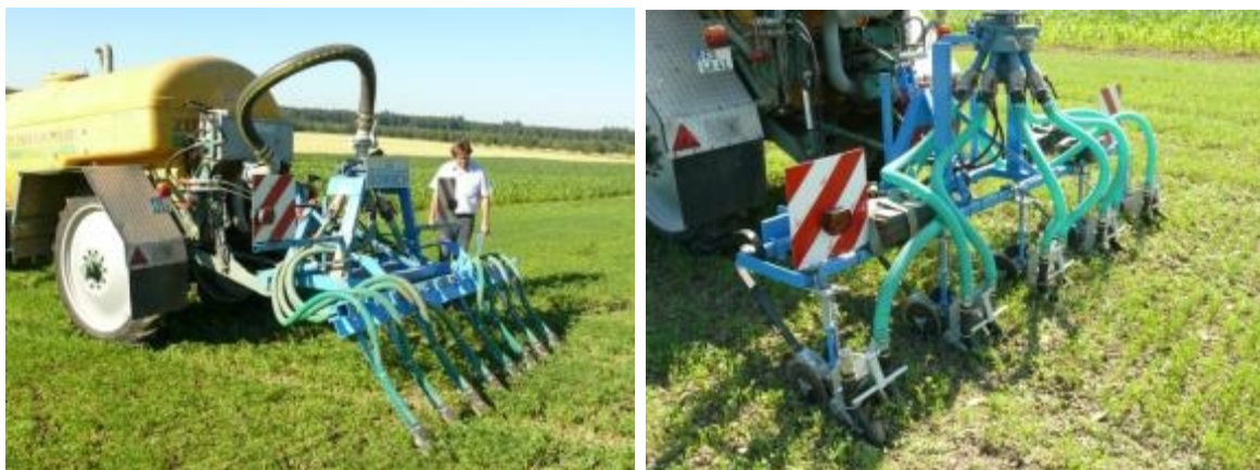
Versuchsgüllefass mit Schleppschuh- (links) und kleinen Scheibeninjektoren (rechts)
