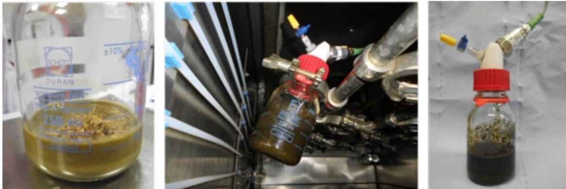
Minibatchversuch im ATS-System: Einwaage der Variante (links), Schwenkmechanismus mit eingespannter Flasche (Mitte), Inkubationsende (rechts)
